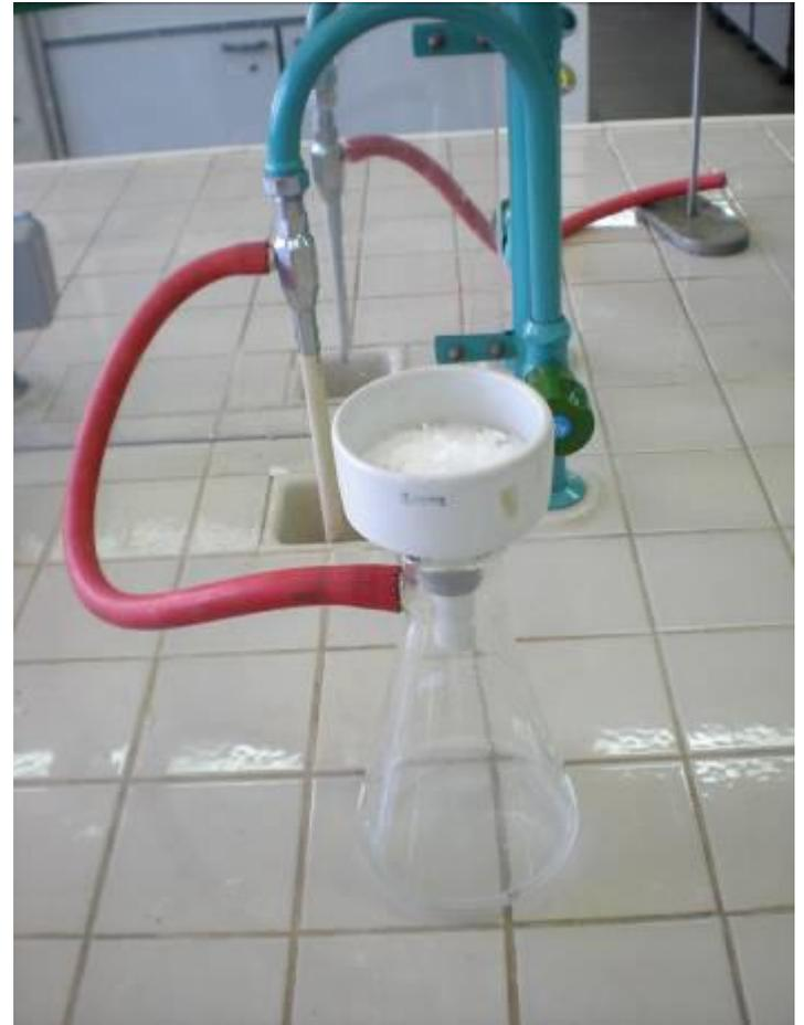
Dopo circa mezz'ora si filtra il solido sotto vuoto su imbuto buchner. Si lava con acido acetico al 6% in etanolo freddo (2 x 5 mL), mantenendo ogni volta il liquido di lavaggio sul filtro senza applicare il vuoto per circa 30 s (il lavaggio rimuove la benzaldeide non reagita e elimina tracce di NaOH che interferiscono con la cristallizzazione).
