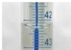
coincidere necessariamente con lo zero della buretta, basta che leggiate il punto esatto sulla scala graduata facendo uso dell'effetto ottico mostrato nella figura a sinistra. In questo caso il valore è 42.3 mL).<sup>3</sup> Fate fluire l'eventuale eccesso di soluzione nel beaker a vostra disposizione.<sup>4</sup>
