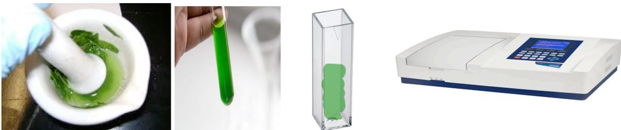
Fig. 3: Passaggi della procedura di estrazione e lettura allo spettrofotometro
